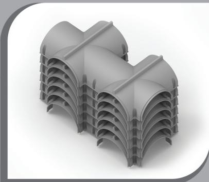
یکی از مهمترین مشکلات در دال های توخالی با قالب های ماندگار در بتن با مقطع مکعب مستطیل، ضعف قالب ها در هنگام نصب و راه رفت کارگران به همراه مصالح بر روی آنها بوده که باعث شکسته شدن آن و نفوذ بتن به داخل قالب ها می گردد. در طراحی قالب کانتون از آنجایی که تمام مقطع قالب به صورت قوس بوده و باعث می گردد نیروهای وارد از حالت خمشی به فشاری تبدیل گردد، شکستگی در این قالب بسیار کمتر بوده که باعث می گردد این معطل اصلی در دال های تو خالی رفع گردد.
