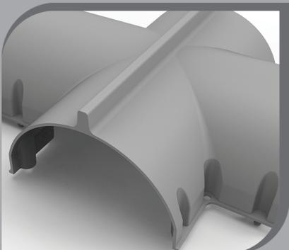
بر روی این قالب ها برآمدگی هایی تعییه شده است که باعث می گردد قالب ها از شبکه میلگرد بالا و پایین فاصله گرفته و بتن بتواند به راحتی دور میلگردها را پوشش دهد و انتقال نیروی کششی از بتن به میلگرد به درستی انجام پذیرد.
